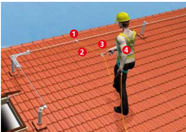
Auffangsystem mit mitlaufendem Auffanggerät einschließlich beweglicher Führung und horizontaler Anschlagrichtung
